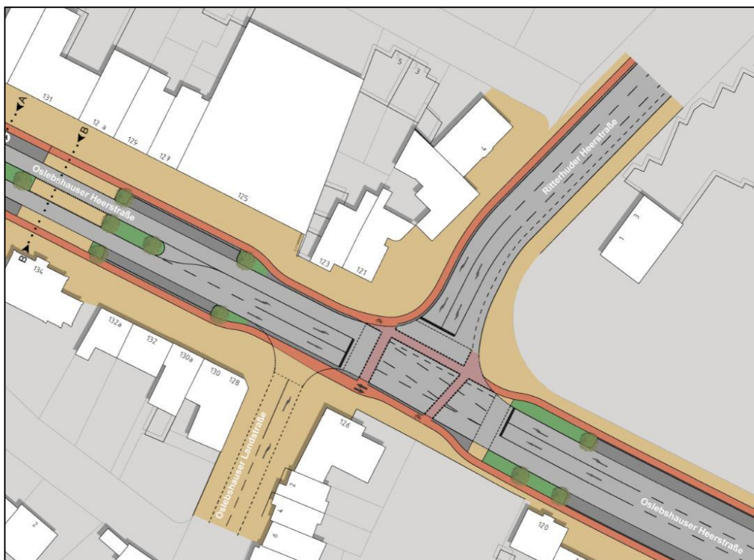
Abb. 2: Geplanter Umbau des Untersuchungsknotens
